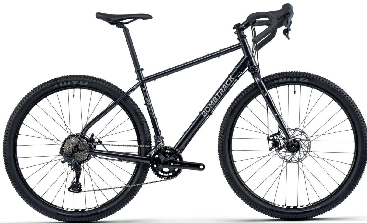
La Beyond 1 è una bici per avventure offroad con dropbar, progettata per portarvi ovunque vi guidi la bussola. Il telaio e la forcella sono entrambi realizzati con tubi in crmo 4130 double butted, affidabili e leggeri, con una moltitudine di opzioni per il montaggio di borracce e portapacchi, unite ai forcellini per i perni passanti.
