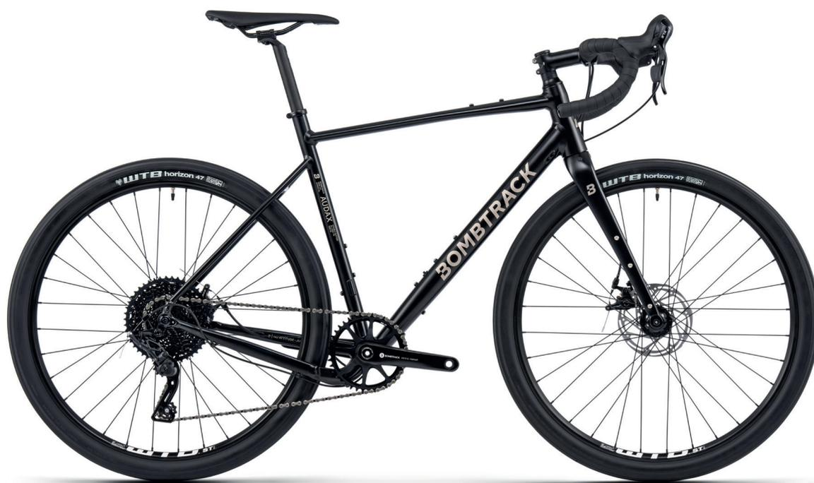
Audax AL è la nostra leggera bicicletta Audax in alluminio, con telaio idroformato a doppio spessore e forcella in carbonio. Abbiamo ottimizzato i profili per ridurre il peso e, allo stesso tempo, abbiamo ovalizzato il tubo orizzontale e abbassato i foderi per una maggiore permessività:
