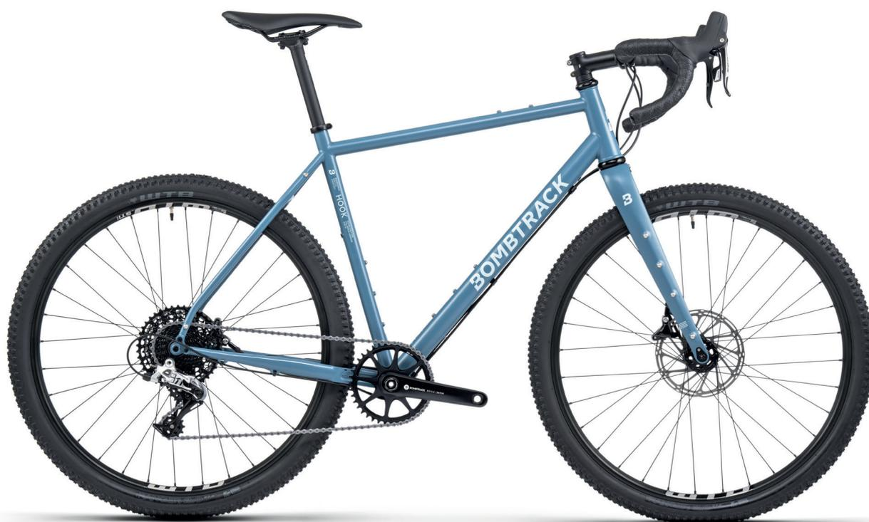
La nostra EXT è il punto in cui la Hook inizia davvero a farvi perdere la testa. Utilizzando tubi in acciaio Columbus Cromor a doppio spessore, un tubo di sterzo tapered, un passaggio interno per la dinamo e i nostri numerosi attacchi sul telaio, la EXT è pronta a tutto.
