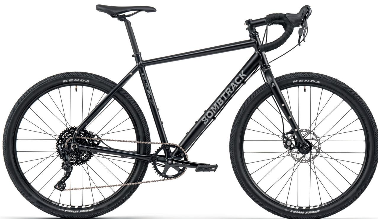
La versione drop bar della nostra leggera Munroe AL, la SG, è la perfetta bici da avventura urbana. Il telaio in alluminio a triplo spessore risponde facilmente agli input provenienti dall'ampio manubrio e offre una guida fluida con pneumatici da 45 mm.
